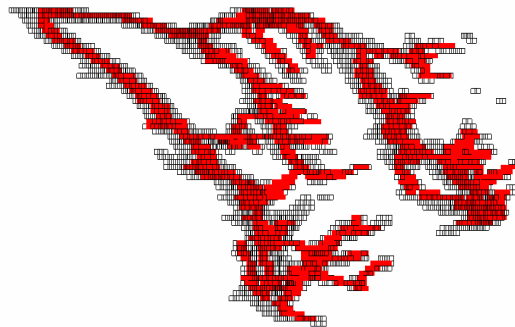
Σχήμα 3.17 Αποτέλεσμα αλγορίθμου λέπτυνσης. Με κόκκινο είναι τα voxel τα οποία ανήκουν στο σκελετό ενώ αυτά με wire μορφή είναι τα voxels που διαγράφηκαν.
