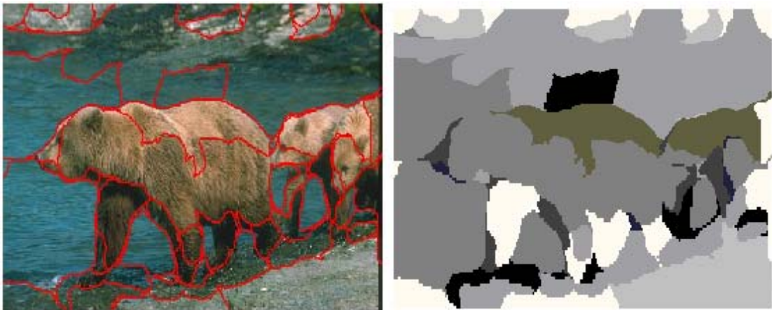
Σχήμα 2.23: Όρια περιοχών που προκύπτουν για K=10 κέντρα με τη χρήση των χαρακτηριστικών MRF και ύστερα από ομαδοποίηση των medoid των υπερ-εικονοστοιχείων
