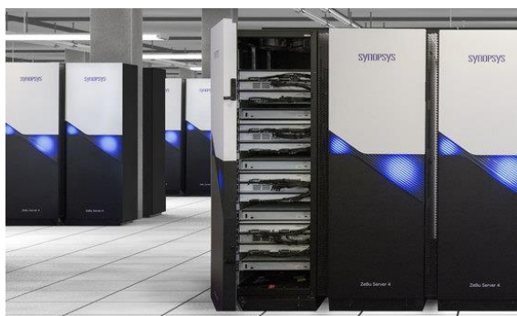
Σχήμα 1.2 - ZeBu EP1 - Μηχάνημα εξομοίωσης που αποτελείται από συσκευές ανάπτυξης πρωτότυπων συστημάτων σε FPGAs
