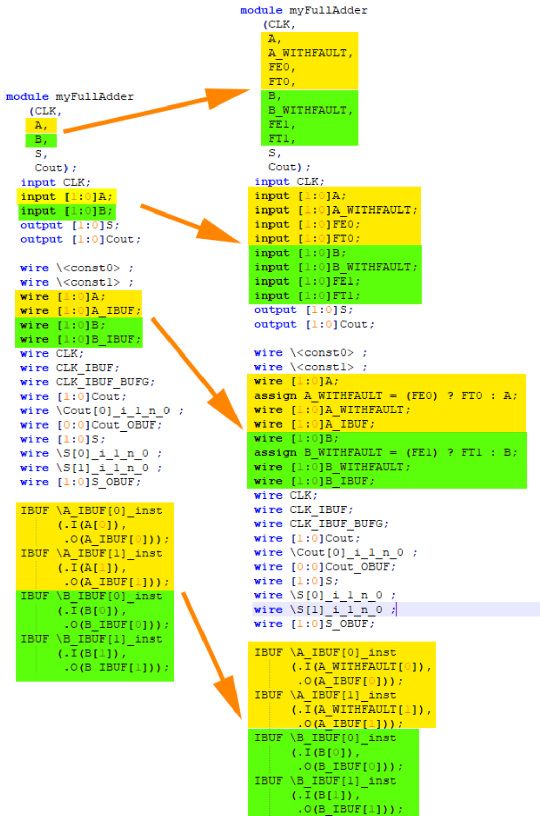
Σχήμα 3.6 - Το αρχείο netlist πριν και μετά από την προσθήκη των Multiplexors
