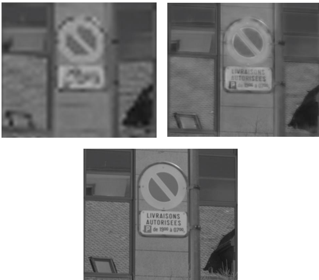
Σχήμα 5.16 Αποτελέσματα του Μοντέλου για Συντελεστή Υπερανάλυσης \times 6 . Πάνω αριστερά η Αρχική Εικόνα (LR), πάνω δεξιά η Εικόνα που Παράγει το Μοντέλο (estimated) και κάτω η Εικόνα Υψηλής Ανάλυσης (HR).
