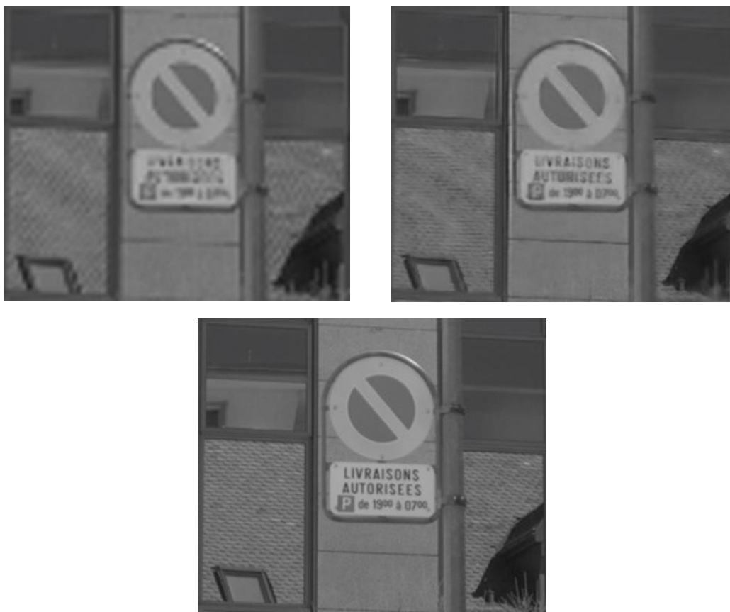
Σχήμα 5.8 Αποτελέσματα του Μοντέλου για Συντελεστή Υπερανάλυσης \times 3 . Πάνω αριστερά η Αρχική Εικόνα (LR), πάνω δεξιά η Εικόνα που Παράγει το Μοντέλο (estimated) και κάτω η Εικόνα Υψηλής Ανάλυσης (HR).
