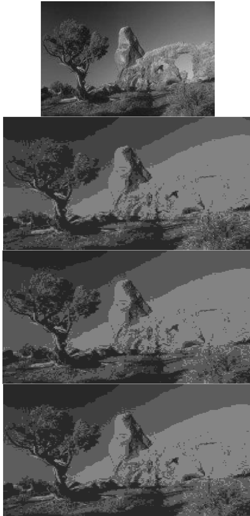
Σχήμα 4.31 Το αποτέλεσμα της κατάτμησης της αρχικής εικόνας “rock_and_tree.jpg” μέσω των τριών μοντέλων: GMM, PsMM, AsPsMM. Κάθε μοντέλο αποτελείται από τέσσερις συνιστώσες κατανομές (ομάδες).
